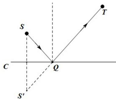
图6 光的平面镜反射性质
