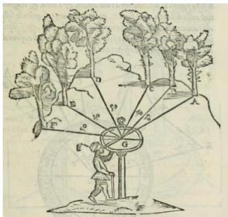
图 7 《测量方法》中的鼓面测量方法
