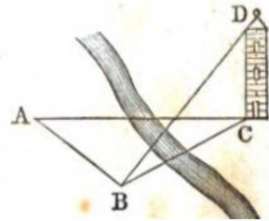
图 8 测量不可到达的垂直物体高度 (2)
