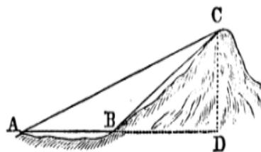
图 7 测量不可到达的垂直物体高度 (1)
