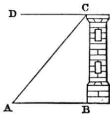
图 6 测量可到达的垂直物体高度
