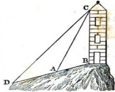
图 9 倾斜平面上测量可到达的垂直物体高度
